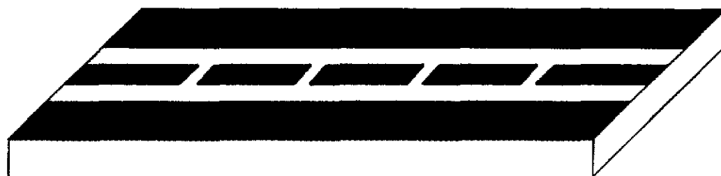
圖 3.1 傳統窄通共面波導濾波器之平面結構。
