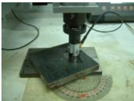
圖 8 超音波裂縫尺寸自動檢測 阻力推進技術領域三個子計畫如圖 9。
