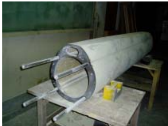
圖 17 後段骨架與外殼製作
