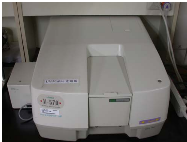
圖 2.1-6 JASCO-570 UV-Visible-NIR 光譜儀。
