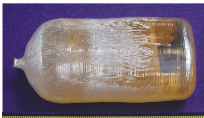
圖 4.1-3 1 mol%鎂摻 SLN 晶體(晶體 2)。
