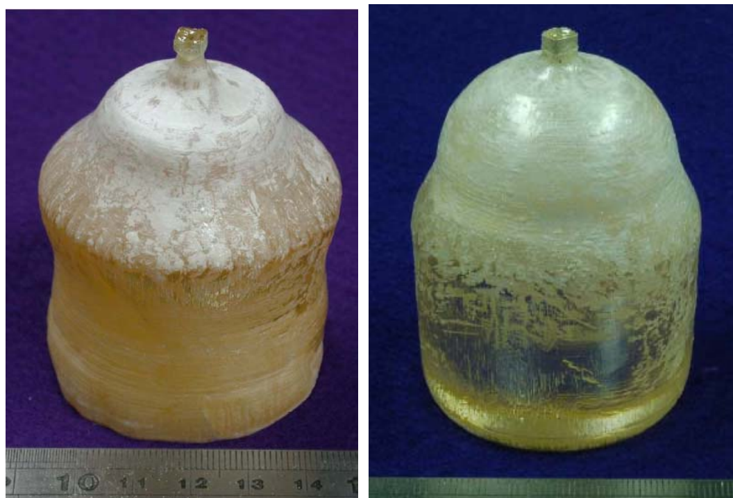
圖 4.4-2 無劈裂之 2mol% ZnO-doped SLN crystal。
