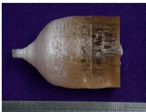
圖 4.2-1 以 \text{Li}_2\text{O} 過量之鈮酸鋰進料組成所生長之鎂摻 SLN 晶體。
