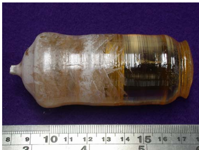
圖 4.1-2 1 mol%鎂摻 SLN 晶體(晶體 1)。
