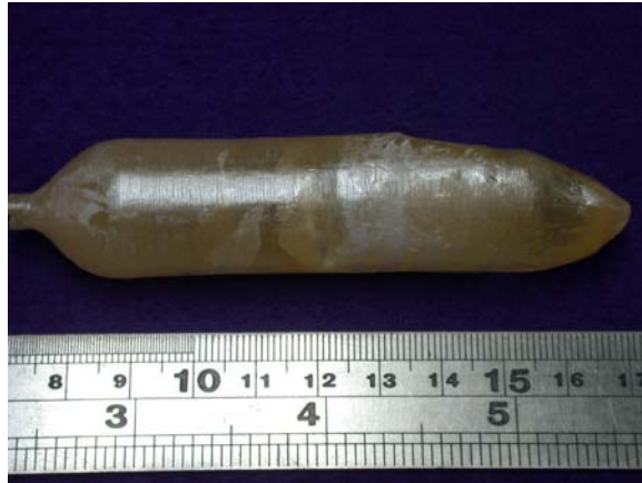
圖 3.2-5 生長過程中變形之 SLN 晶體。
