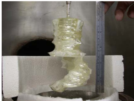
圖 3.2-2 鈮酸鋰晶體（使用重量回饋控制策略）。
