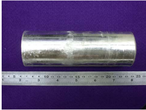
圖 3.2-8 白金坩堝（內徑 5cm；高度 15.5cm；厚 1mm）。
