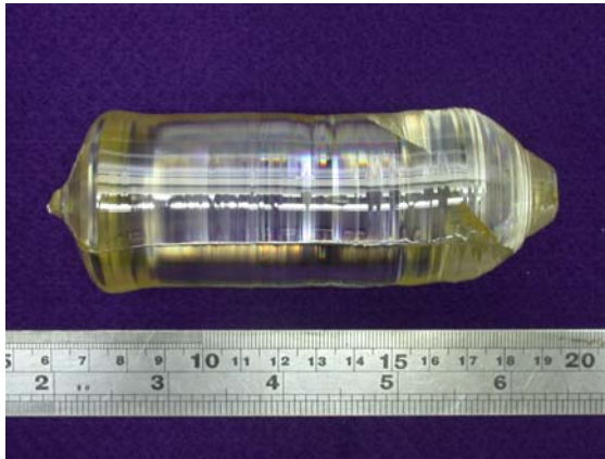
圖 3.2-3 鈮酸鋰晶體（使用重量生長速率控制策略）。
