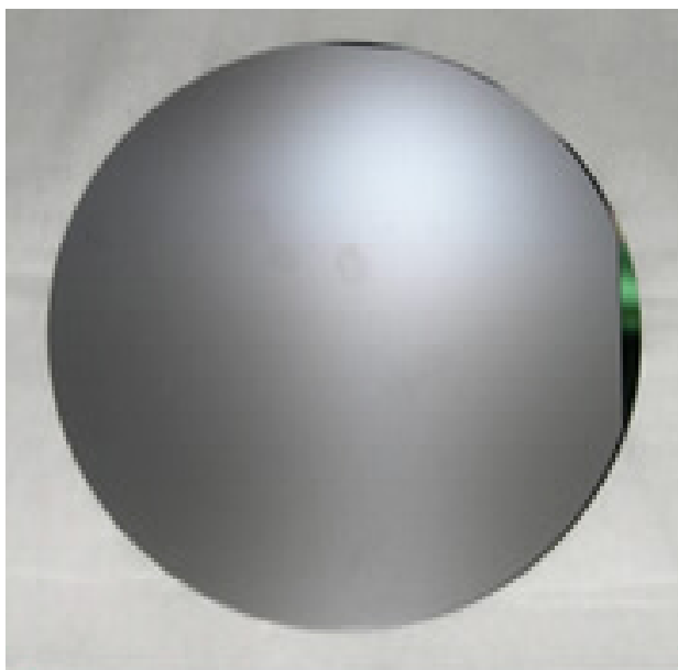
圖六 利用增強反射體照射均度設計之燈管型晶圓鍵結機台進行晶圓鍵結。
