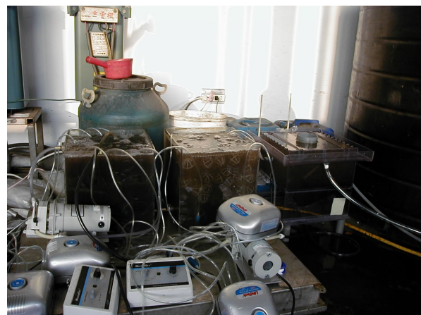
圖 6. 完工後之小型活性污泥/生物接觸曝氣法合併系統
