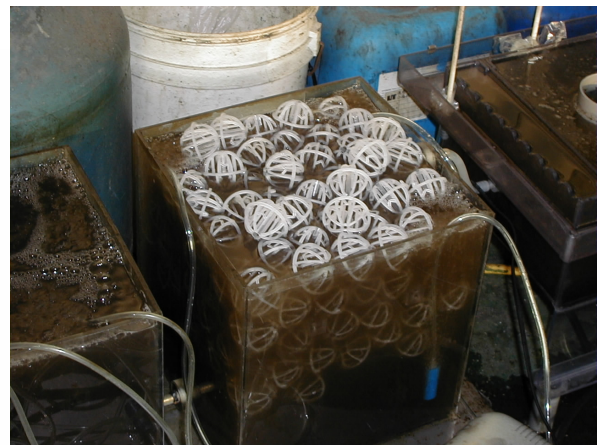
圖 5. 接觸濾材之安裝
