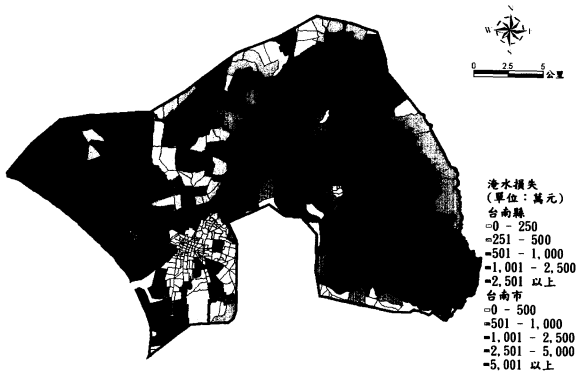
圖 5-20 鹽水河流域 50 年重現期降雨事件淹水損失評估
