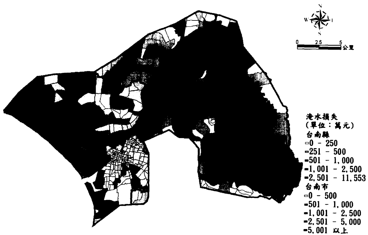
圖 5-19 鹽水河流域 25 年重現期降雨事件淹水損失評估
