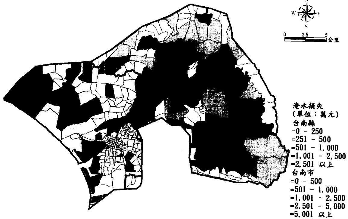
圖 5-16 鹽水河流域 2 年重現期降雨事件淹水損失評估
