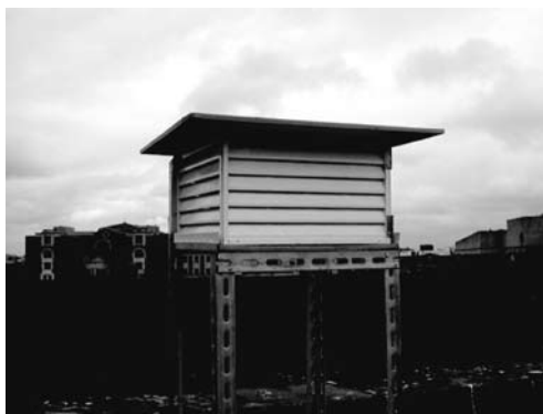
圖1 設於台北之沙塵暴微粒的雙層遮雨採集器，內有培養皿及玻璃載玻片
