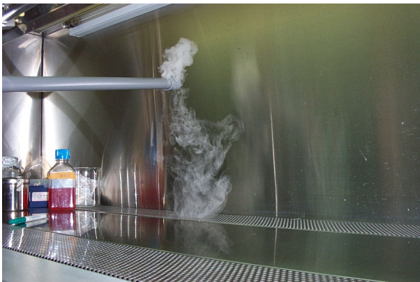
圖 6 櫃內工作區處的放煙測試顯示櫃內四周的層流效果極差
