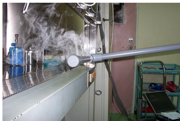
圖 5 開口面處的放煙測試顯示煙霧無法被吸入工作台前緣的槽縫中
