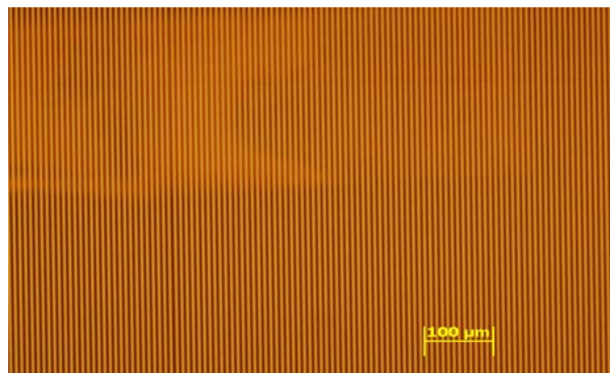
圖 5.4 AFM 訊號量測之樣本，結構週期 8\mu\text{m} 。
