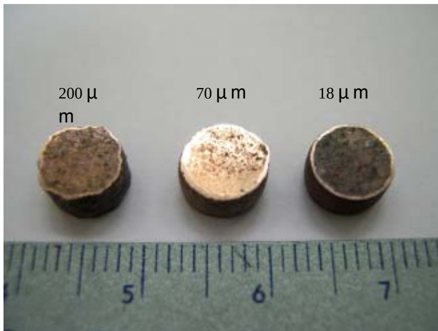
圖 5.4 \lambda = 1 壓縮過後不同結晶的 C1200 壓縮試片
