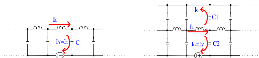
(a) 微帶線跨越槽線處迴流路徑示意圖
