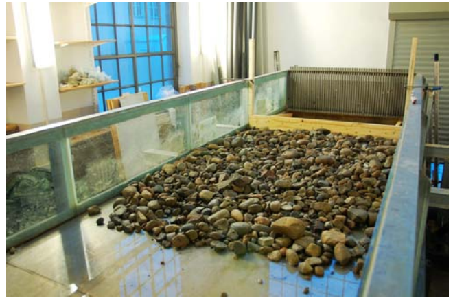
圖11 德國柏林自由大學之水工模擬實驗槽
