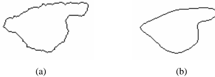
圖 V-C-10：Cubic B-Spline 平滑化圖例，(a)為原始腫瘤邊緣，(b)經由 Cubic B-Spline 平滑後之腫瘤邊緣。
