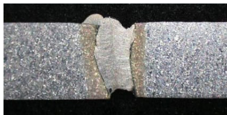
圖 2 410 不銹鋼氧化試片經雷射銲接後表面 underfill 的現象
