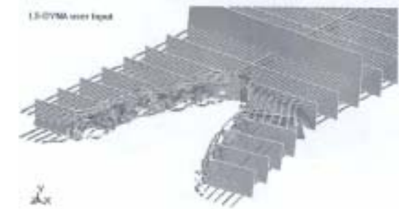
圖 8：模型一腹板和加強筋材結構被壓潰的情況
