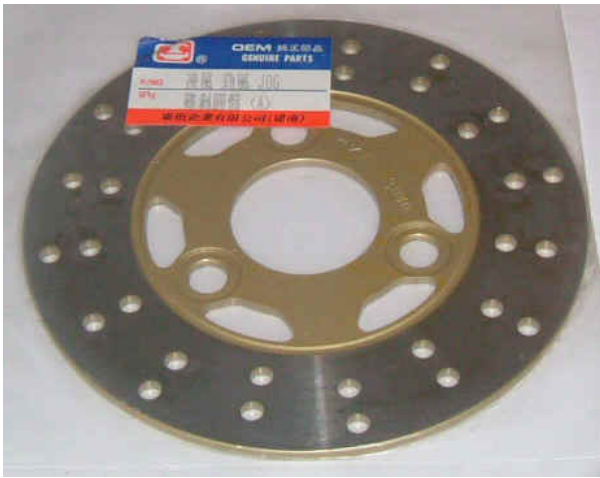
圖 48、YAMAHA 的輕型機車碟盤
