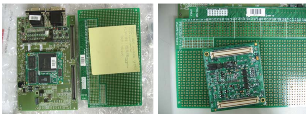
圖 83、C167 微處理器整體外觀照片，右圖為 C167 背面 pin connection 之放大
