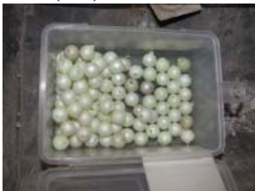
圖 4 追蹤用顆粒；10mm 球型塑膠顆粒
