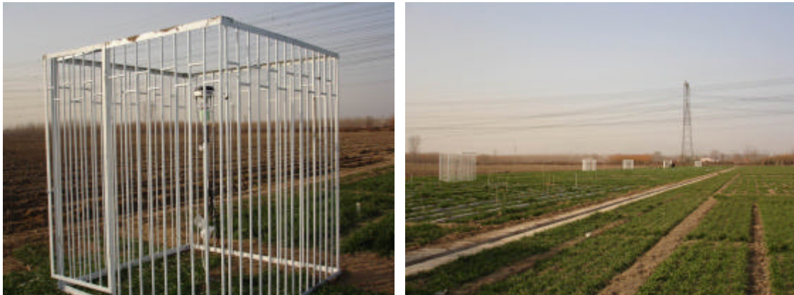
圖 11. 安裝於中國大陸的 FS 與防偷設施 (Hirafuji, 2005b)
