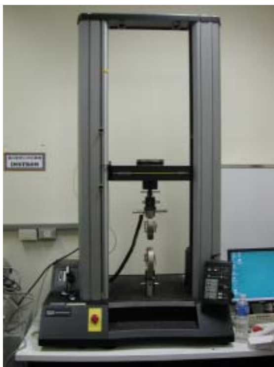
圖 3: 以 Instron 材料試驗機測試光纖試片的拉伸強度。
