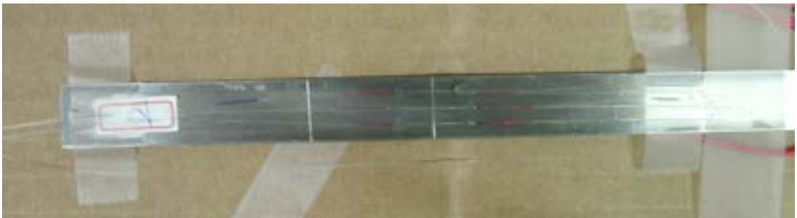
圖 4： 貼附在彈簧鋼片上的光纖光柵感測器。
