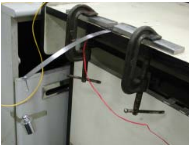
圖 5： 利用彈簧鋼片懸臂樑變形施予光纖光柵不同之變形量。
