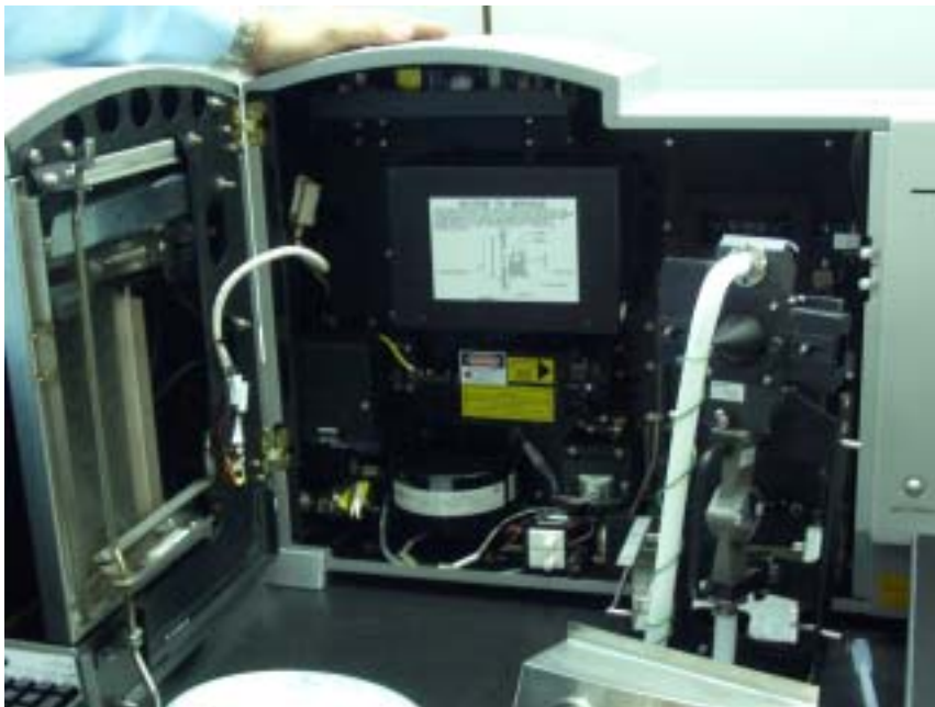
圖一、雷射粒徑分析儀 (BECKMAN COULTER LS TM 13 320) 之內部結構。
