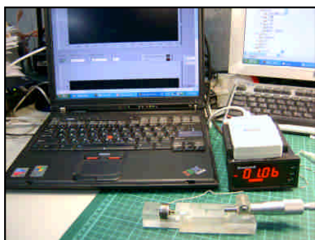
圖8:攜帶式軟骨黏彈鬆弛特性力學測試平台
