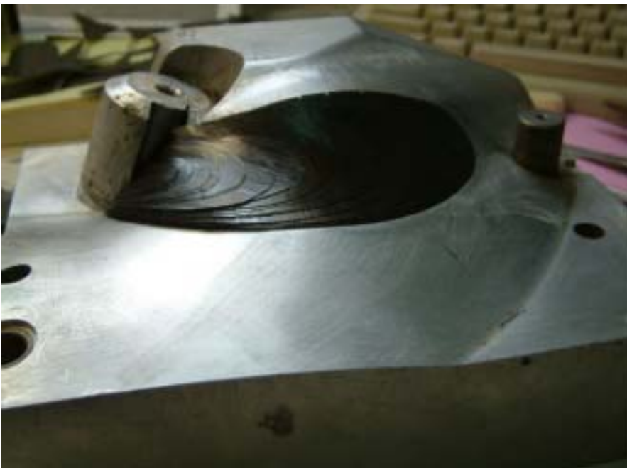
圖 5-6. 在 DTNSRDC-4383 的模具上積層
