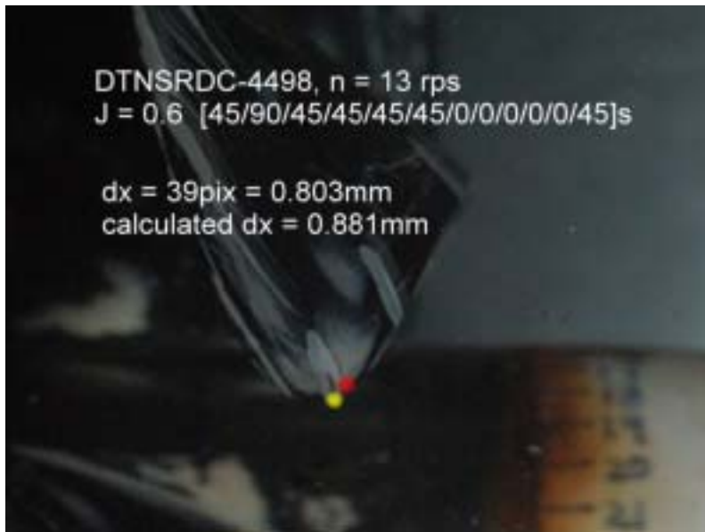
圖 5-39. 4498 螺槳在 n = 13 rps 之下的變形量
