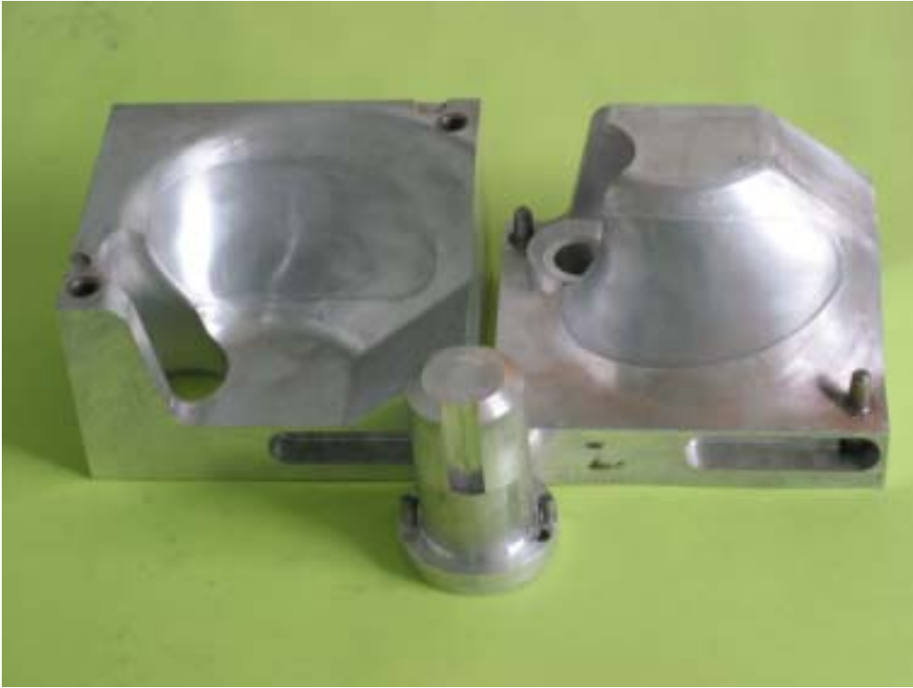
圖 5-1. DTNSRDC-4498 之鋁合金模具
