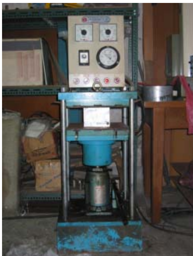
圖 5-7. 葉片於熱壓機中熱壓成形
