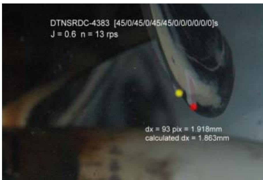
圖 5-37. 4383 螺槳在 n = 13 rps 之下的變形量
