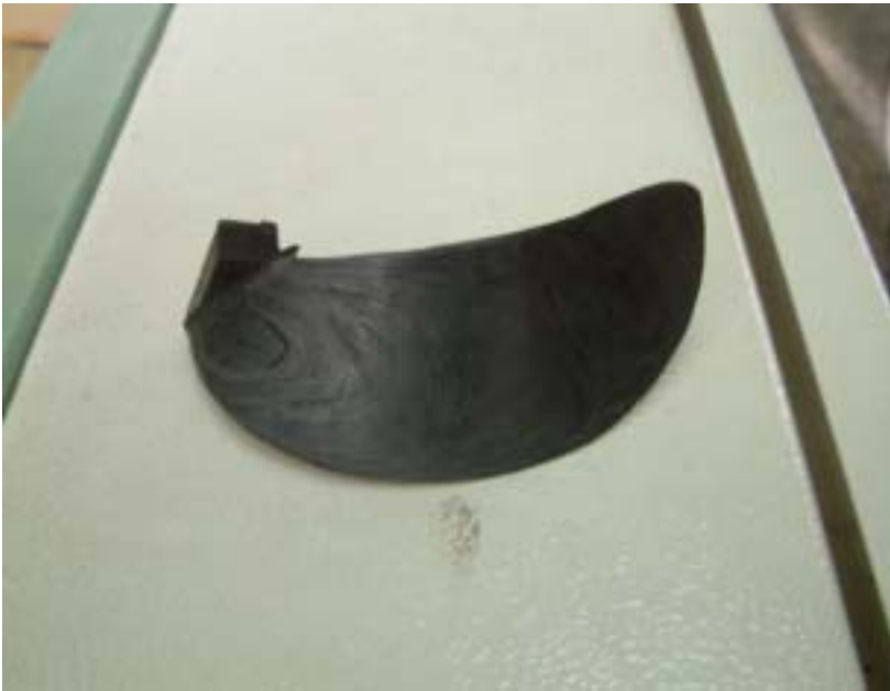
圖 5-9. 修整邊緣後的葉片
