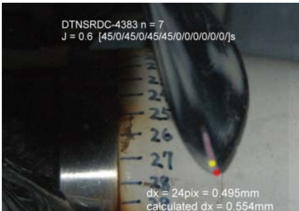
圖 5-36. 4383 螺槳在 n = 7 rps 之下的變形量
