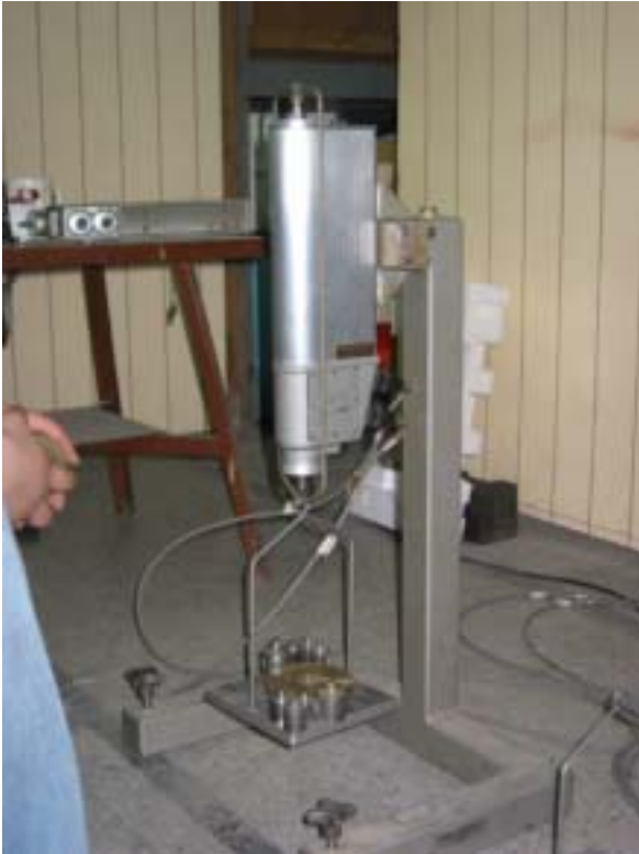
圖 5-13. 進行動力儀推力校正
