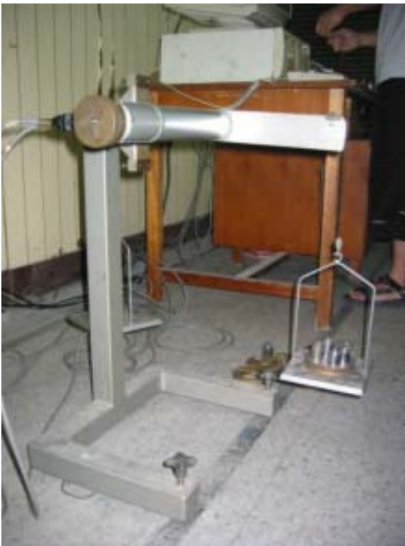
圖 5-14. 進行動力儀扭力校正
