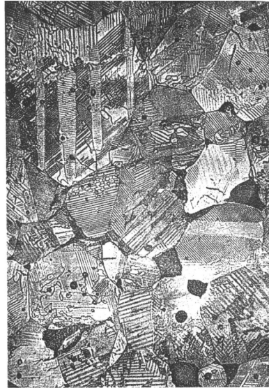
圖六：鈦酸鋇陶瓷晶域與晶域壁之微結構 [17]。
