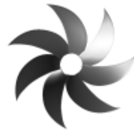
圖11 七葉潛艦用高歪斜螺槳 Model-B
