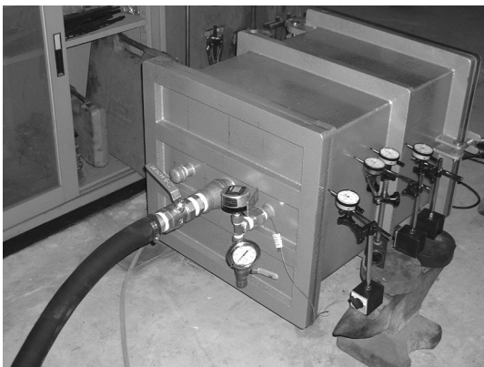
圖 3 使用千分計進行位移試驗
