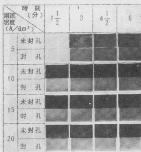
圖14 5% HCl, 20°C, AC 9V 之陽極處理條件下, 電流密度及處理時間對試片表面變黑程度的影響。
