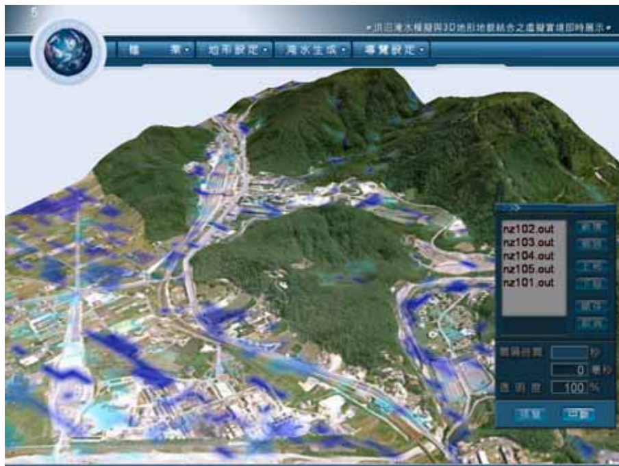
圖 5.1.3 結合 3D 立體地形圖、航照圖及淹水模擬
