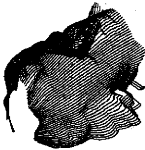
圖 3 B-Spline Curve Fitting 後之貝多芬點群資料。
